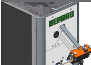
Les chargeurs à balancier ou à segments sont utilisés, lorsque les composants doivent être alimentés sans impact, sans frottement et de façon silencieuse. Nos système d'alimentation à balancier couvrent les tailles de vis de M2 à M6, et conviennent parfaitement pour les vis jusqu'à une longueur de 25 mm.
