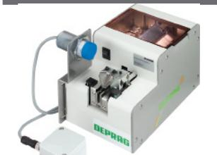
Les distributeurs de vis sont utilisés lorsqu'un système d'alimentation n'est pas rentable en raison d'un faible volume de vis à assembler. Un distributeur de vis permet la mise en œuvre de vis M1 à M5 d'une longueur de tige allant jusqu'à 25 mm. Même les vis qui ne peuvent pas être approvisionnées via un tuyau d'alimentation à cause de leurs dimensions inadéquates sont compatibles avec nos systèmes d'alimentation.
