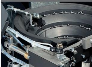
Les systèmes d'alimentation DEPRAG à embase vibrante sont particulièrement adaptés aux vis allant de < M1 à M8. et sont compatibles avec des longueurs de tige de 5 mm à 50 mm.
