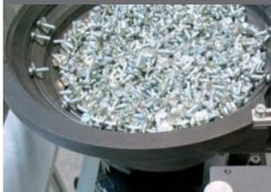
Si les dimensions ne permettent pas une alimentation par tuyau, par exemple lorsque le rapport entre le diamètre des têtes de vis et la longueur totale des vis est inadéquat, nous vous proposons des solutions spécifiques, comme le procédé Pick-and-Place avec prise par aspiration ou retrait par préhenseur.
